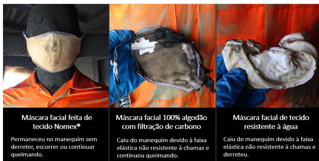
Figura 14 – Performance de três máscaras de composições diferentes após simulação de incêndio.
